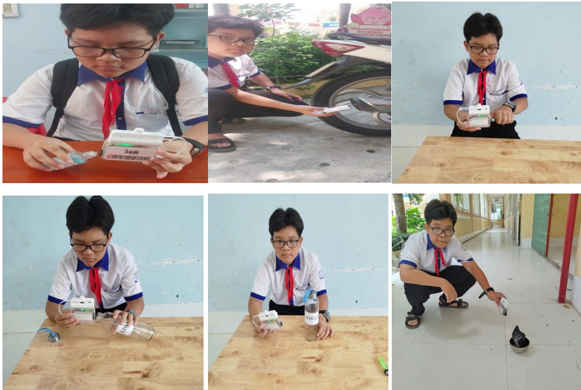
Hình ảnh: Thử nghiệm nhiều khí CO có trong nhiều loại khí độc: Khói đốt từ động cơ xăng dầu (máy phát điện, xe máy), khói từ than, khí gas, ngoài ra còn nhận biết được độ Cồn trong không khí và khí thở.
